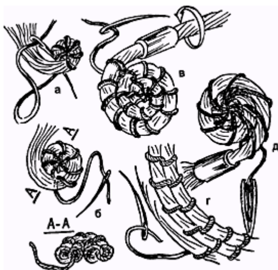
Рис. 1. Спиральное плетение: а - начало плетения; б - соединение жгута бечевкой; в - приспособление для контроля за толщиной жгута; г - окончание плетения; д - челнок для стягивания жгутов.
